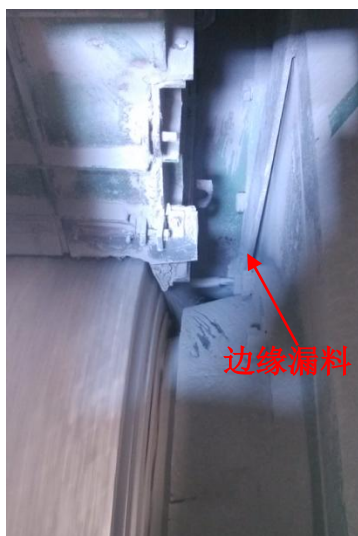
(a) 辊子端面单层侧挡板 边缘有漏料
