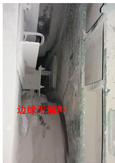
(b) 骑辊式双层侧挡板观 察不到边缘漏料
